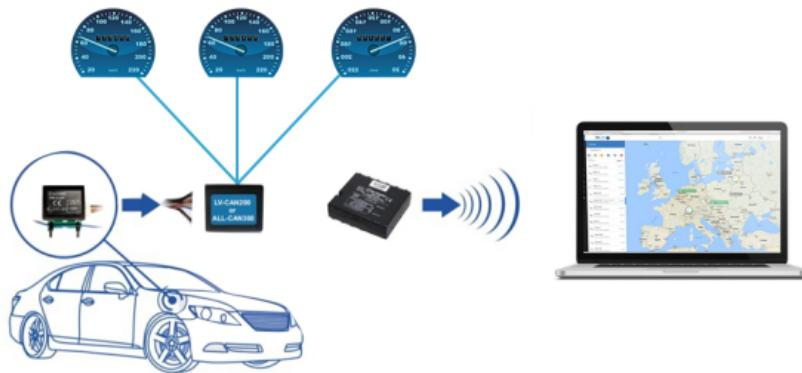
يُوفِر نظام تتبع المركبات TMT GPS مُعْظَم الـ **b**بيانات من الـ **كـمـ بـيـوـتـرـ** المـوجـودـ عـلـىـ مـنـتـنـ الـمـرـكـبـةـ **CANbus** مـثـلـ السـرـعـةـ، إـسـتـهـلاـكـ الـوقـودـ، وـالـمـسـافـاتـ الـمـقـطـوـعـةـ وـخـدـمـاتـ الـوـيـبـ تـسـمـحـ لـهـاـ لـلـإـنـدـمـاجـ مـعـ الـأـنـظـمـةـ الـأـخـرـىـ وـجـعـلـ الـعـهـلـيـاتـ أـكـثـرـ فـعـالـيـةـ وـدـلـاقـ دـلـاقـ جـدـيدـةـ.
